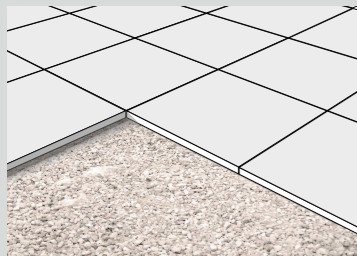
POSA SU GHIAIA O SABBIA INSTALLATION ON GRAVEL OR SAND
